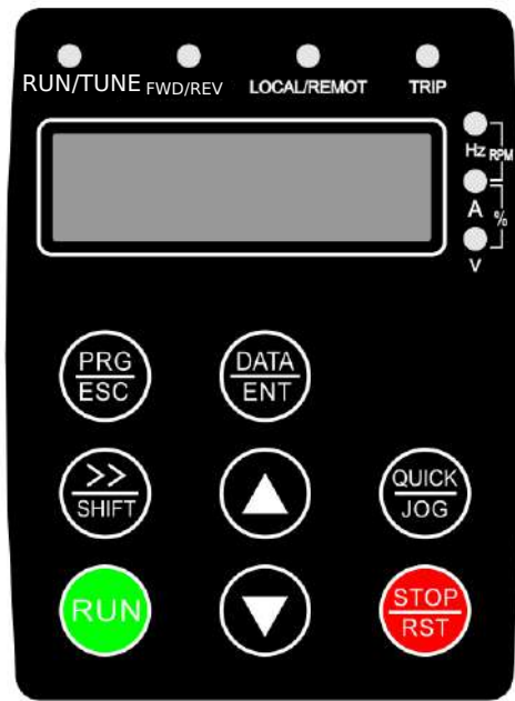
Hình 4-1 Sơ đồ bàn phím cho biến tần
